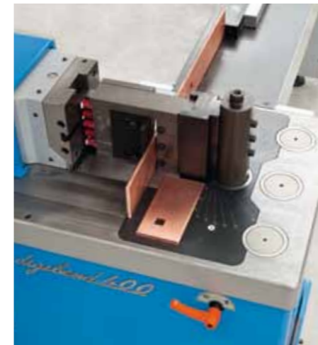
Unidad de corte para barras planas. Máx. 150 x 12 mm.
