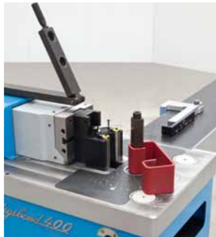
Herramienta de Plegado con perno \varnothing 50 mm, H=200 mm, con matriz V de pernos pivotantes y barra antiflexión. Máx. 200 x 8 mm. Pendiente de patente.
