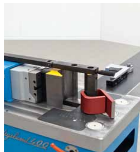
Punzón perno \varnothing 80 mm con barra antiflexión para plegado cerrado (tubular) de barras gruesas. Máx. 200 x 15 mm.
