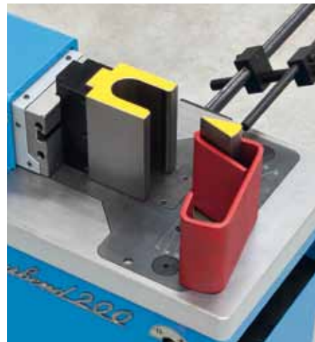
Herramienta de plegado a 30° con matriz U para plegado de barras planas hasta 30°. Máx. 16 x 200 mm.
