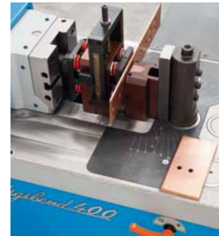
Unidad de punzonado para perforar hasta \varnothing 30 mm. Espesor Máx. 12 mm.
