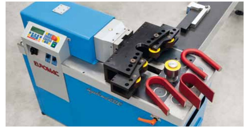
Dispositivo de curvado con 4 mordazas para plegado de barras y tubos circulares, cuadrados y rectangulares hasta 180°. Máx. 100 x 20 mm o \varnothing 50 mm.
