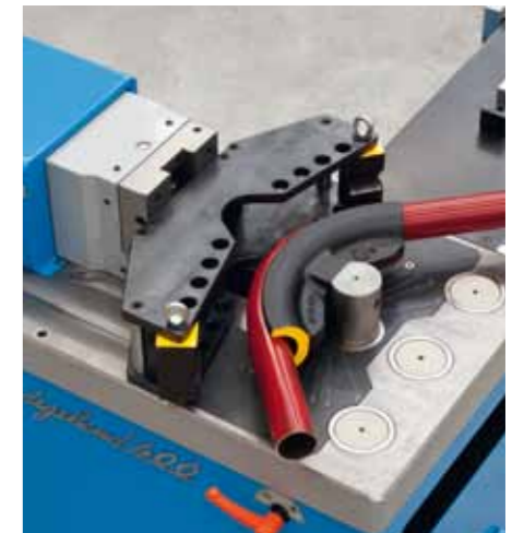
Dispositivo de curvado con 2 mordazas para tubos de gas desde 17.2 mm hasta 60.3 mm y redondos macizos hasta 90°.
