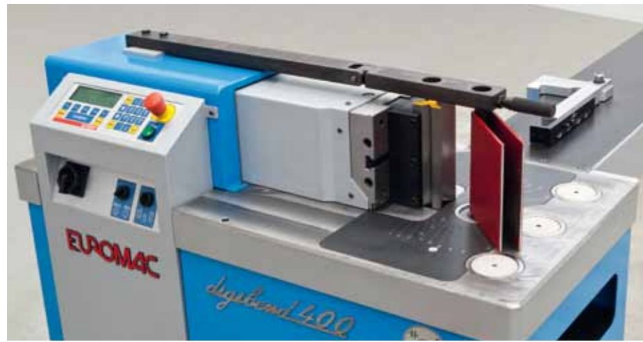
Herramienta de plegado en U con pin \varnothing 30 mm, H=200 mm y barra antiflexión. Máx. 200 x 5 mm.
