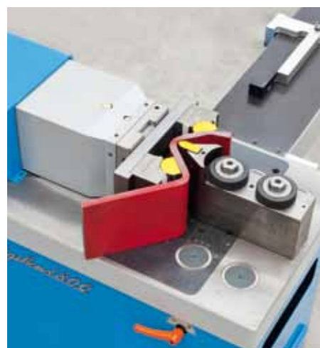
Matriz V de pernos pivotantes (plegado libre de marcas) para altos espesores. Máx. 200 x 40 mm.
